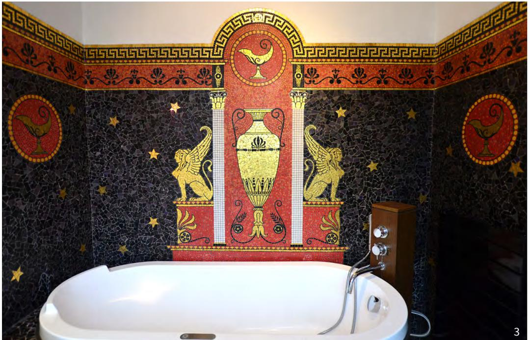
Les tesselles de grès cérame, fabriquées de façon industrielle à partir des années 1920, composées d'argile cuite à haute température et colorées par des oxydes métalliques (cobalt, chrome...), offrent la plus grande résistance au gel, à l'usure, et détrônent l'usage du marbre plus coûteux en main d'œuvre. Elles offrent en outre une variété de formes : rectangulaire, ronde, carré, hexagonale, en éventail... aux couleurs mates.
